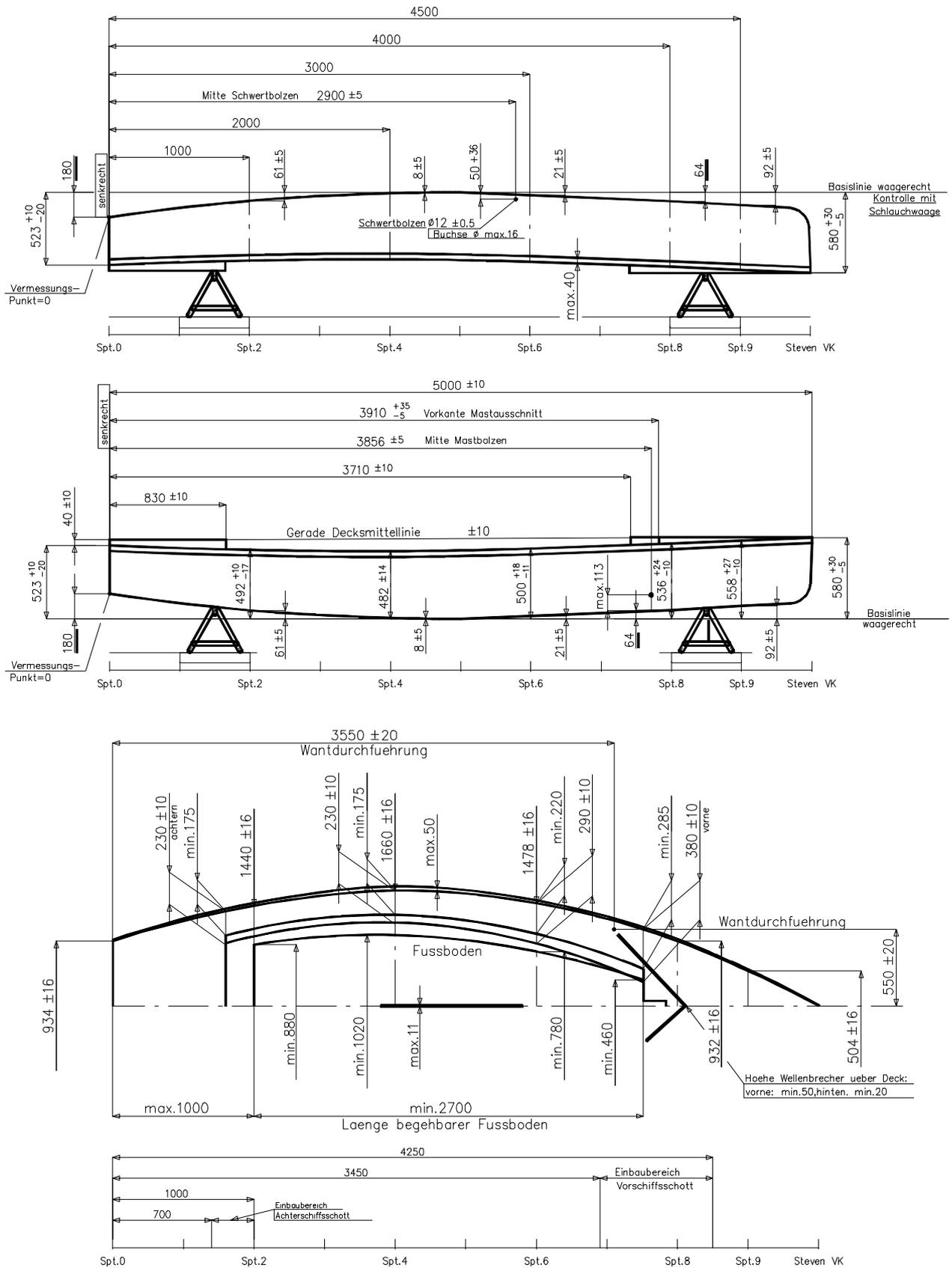
**Abb. 4: Schnitt Spant 4, beispielhaft**
